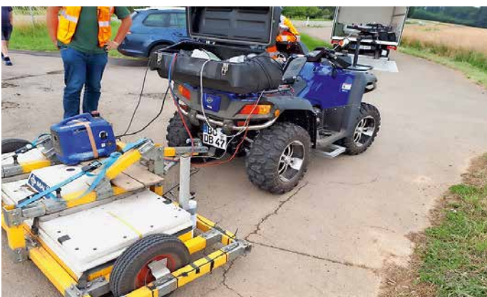
Abbildung 4: Das Georadarmessgerät wird mit einem einfachen Quad während des laufenden Straßenverkehrs gezogen
