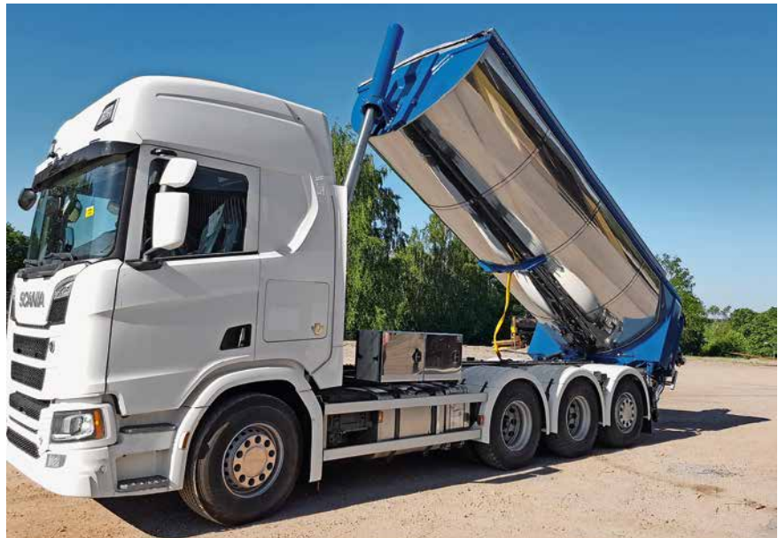
Der neue CMT Kipper-Aufbau mit Frontpresse
