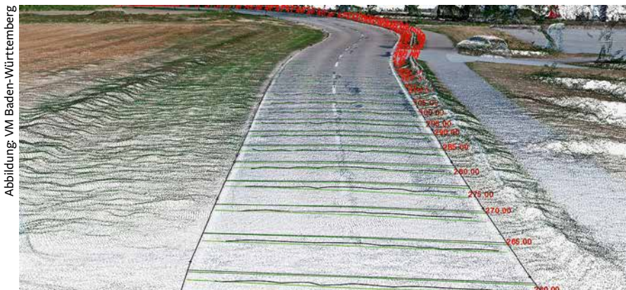
Abbildung 2: Visualisierung der L 1151 nach Datenaufbereitung der Drohnenaufnahme
