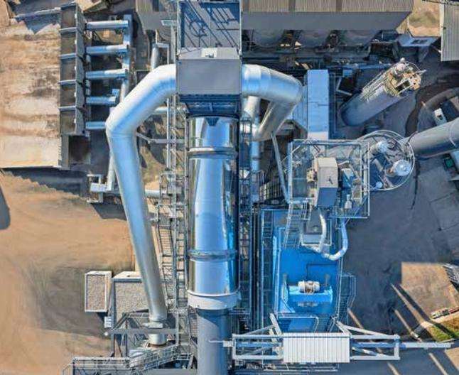
Der Brenner feuert in den Heißgaserzeuger und die erwärmte Umluft erhitzt das Asphaltgranulat in der Recyclingtrommel indirekt und materialschonend
