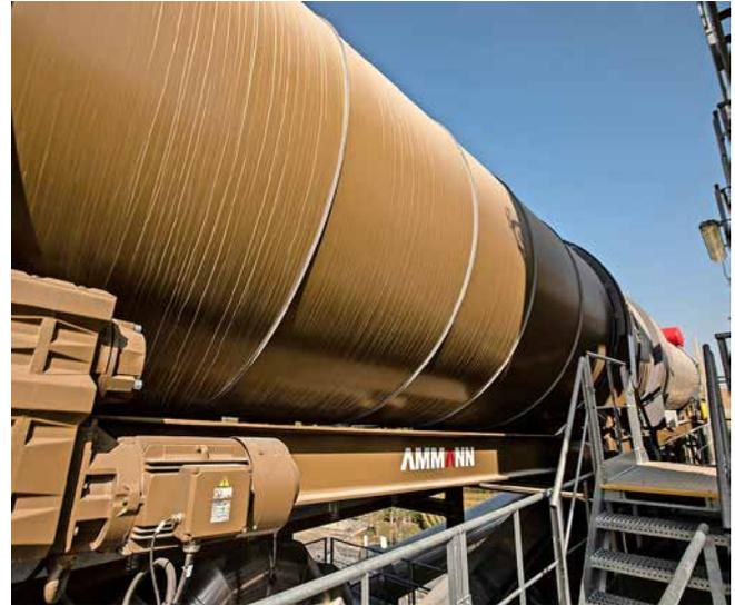
Grundlage für die Verwendung hoher Recyclinganteile ist die Recyclingtrommel HRT
