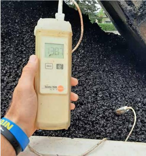
Bild 1: Durchschnittstemperatur von SMA 11 S TA bei der Übergabe vom Lkw in den Beschicker
