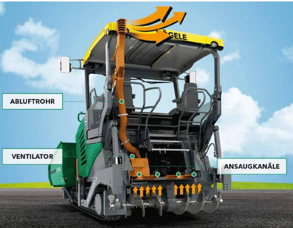
Das Ventilationssystem von Vögele an einem Super 2100-3(i)
