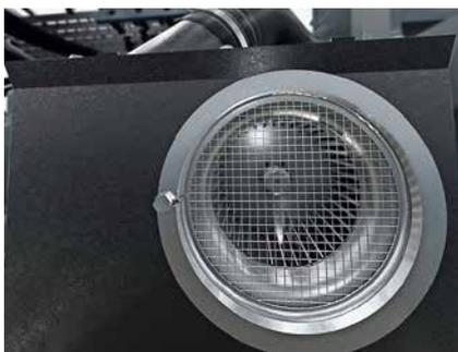
Der Ventilator konnte im Inneren der Vögele-Fertiger platziert werden
