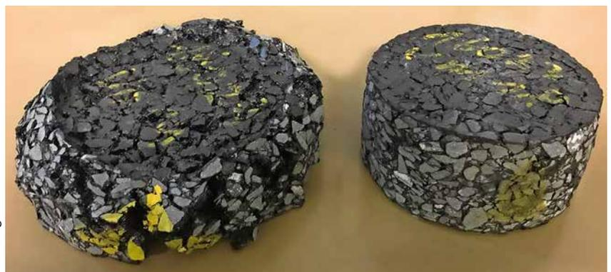
**Bild 1:** Probekörper nach Druckschwellversuch bei 50 °C ohne (links) und mit Reaktivmodifikation durch B2Last (rechts)
