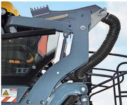
Das Abluftrohr wird für den Transport zusammen mit dem Dach abgeklappt
