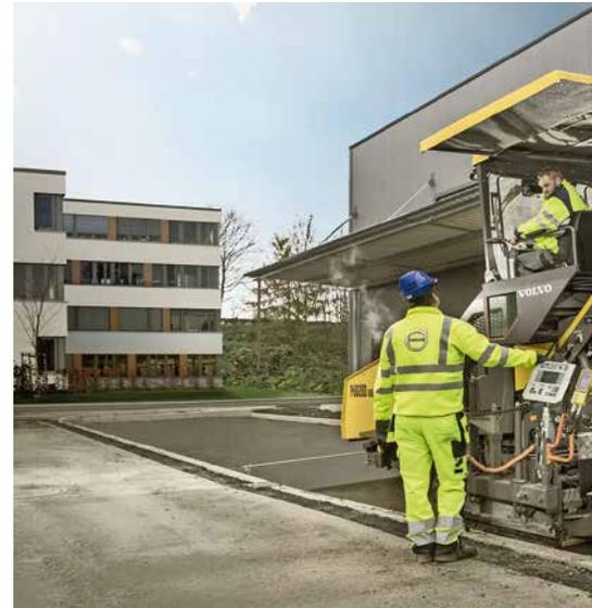
Klein gehaltene Ventilatoren und damit eine geringe Geräuschzunahme ermöglichen eine problemlose Verständigung von Fahrer und Bohlenbediener
