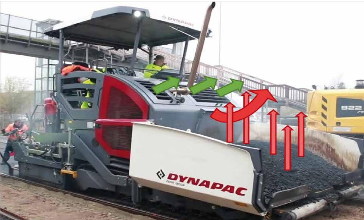
Die warme Motorluft zerstreut zusätzlich Dämpfe aus dem Kübel
