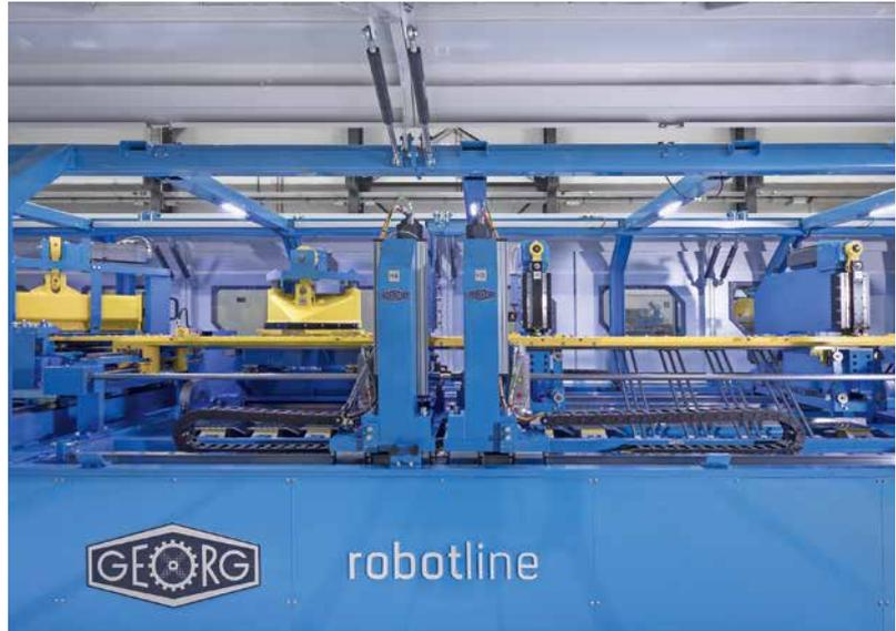
Der Roboter stapelt die aus dem Stanz- und Schneidteil in den Stapler transportierten Bleche automatisch und mit hoher Wiederholgenauigkeit.
