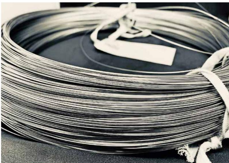
Bei Rohrlängen von teilweise bis zu 3 km (hier 1,5 km) und einem Innendurchmesser von 1 mm oder weniger ist die Reinigung von Rohr-Coils keine Selbstverständlichkeit.
