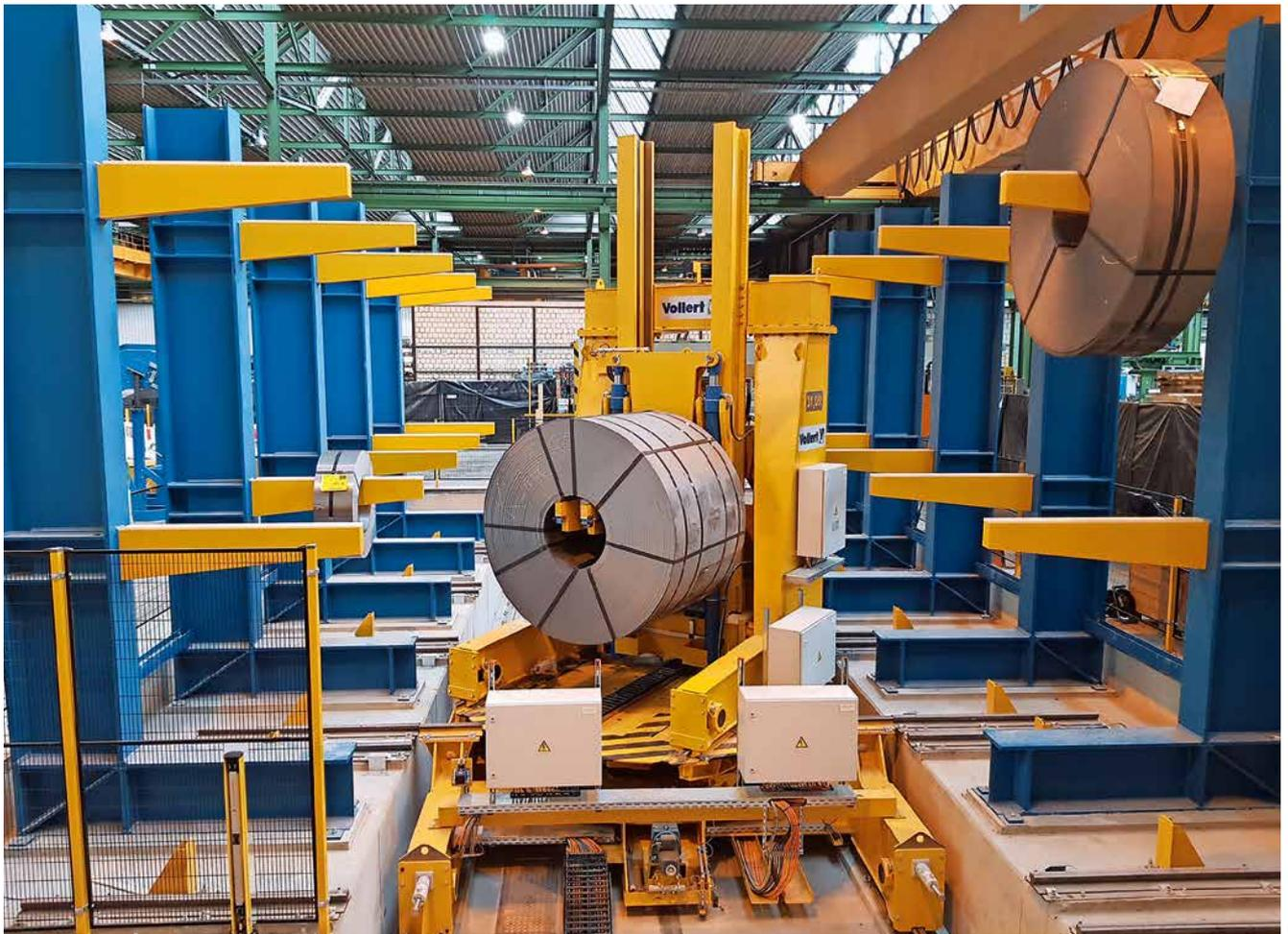
Fahrbar, drehbar und platzsparend: Kragarm-Pufferlager bei Bilstein.
