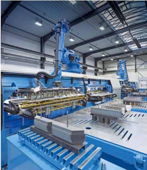
Je nach Ausführung stapeln die Precisioncut-TBA-Robotline-Anlagen von Georg mehrere Kerne synchron.
