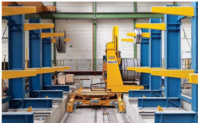
... ermöglicht den direkten Zugriff auf die bis zu 31 t schweren Stahl-Coils.
