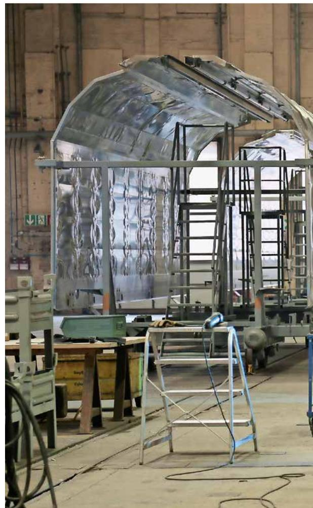
Gerade in Branchen, für die Leichtbaukonzepte eine wichtige Rolle spielen, bietet das nun entwickelte einseitige Punktschweißen völlig neue Möglichkeiten. So zum Beispiel auch im Schienenfahrzeugbau – der Kernkompetenz der SLV Halle –, wo Profilkonstruktionen und in Zukunft auch Rohrstrukturen zu erheblichen Gewichtseinsparungen führen können.
