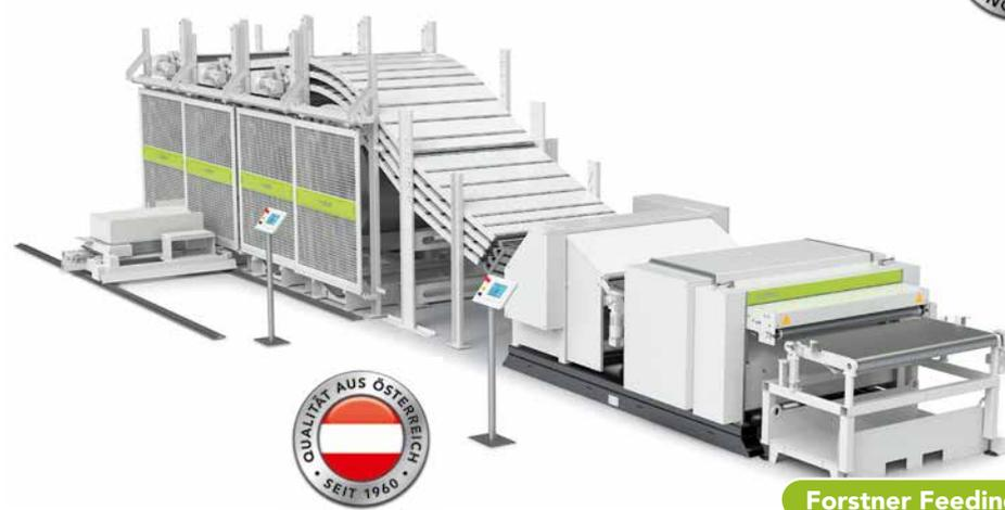
FORSTNER Mehrfach-Abcoilanlage mit vollautomatischem Blechwechsel innerhalb einer Minute für maximal sechs Coils bis 7 Tonnen und integrierter Ebenheitsmessung
