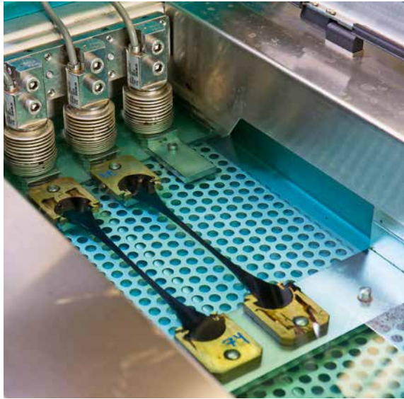
Testverfahren im Labor des Herstellers zeigen die Elastizität von Bitumenprodukten.
