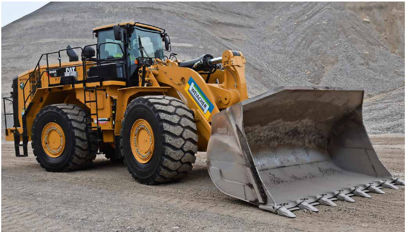
Der knickgelenkte Radlader Caterpillar 988K XE wurde von Avesco geliefert und steht heute in der Kiesgrube Weiach im täglichen Einsatz.
