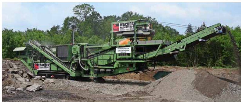
Auf der raupenmobilen Gipokombi RC 130 FDR DA sind der leistungsstarke Prallbrecher und die grosse 2-Deck Siebmaschine montiert.
