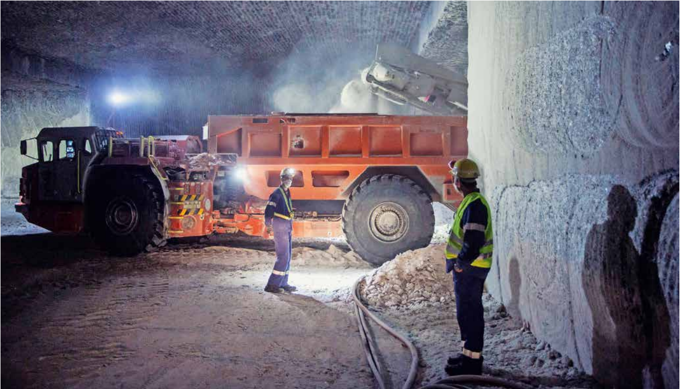
Ein Sandvik MB770 befüllt einen Sandvik TH540 Muldenkipper, der dann die Fracht zum Förderband transportiert.
