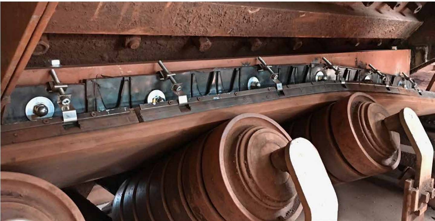
Seitenabdichtung „Airscape“ - entwickelt von Wilfried Dünwald.
