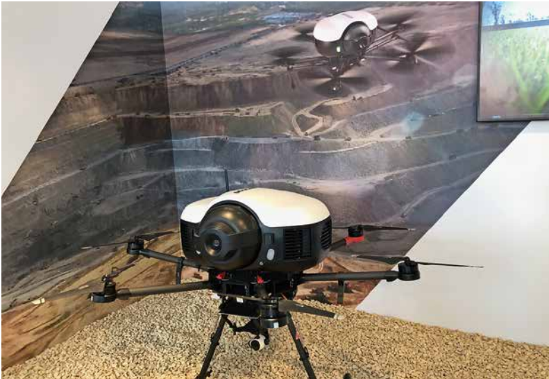
Diese Drohne fliegt mit Wasserstoff.
