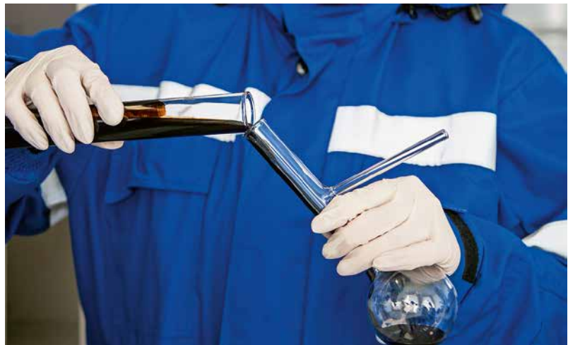
Bei der Ölanalyse im Labor lassen sich Rückschlüsse auf den Maschinenzustand ziehen.
